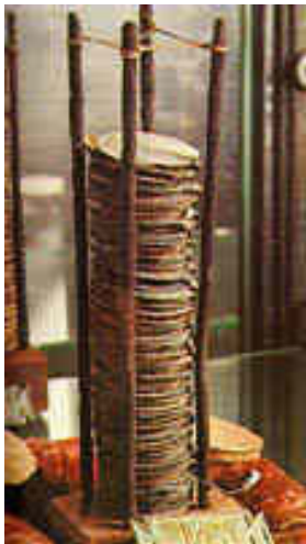
Fig. 7 Links: "zuil van Volta Rechts: Door Volta geschetste mogelijkheden voor vergroting van de zuil en de daarmee opgewekte spanning (uit: Philosophical Transactions deel 2, 1800
